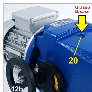
12b) Introduire 0,19 kg (*) de graisse synthétique SHELL RETINAX EPX2 par le bouchon 20.
