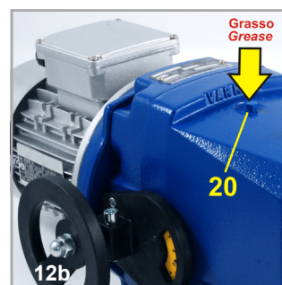
12b) Introdurre 0.19 kg (*) di grasso sintetico SHELL RETINAX EPX2 dal tappo 20
