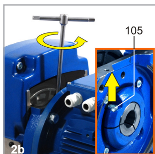
2b) Desserrer la vis 105 du joint pour le serrage de l'arbre du moteur.
